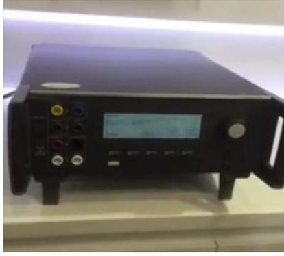
شكل رقم (10) جهاز اختبار القطع الجراحي
