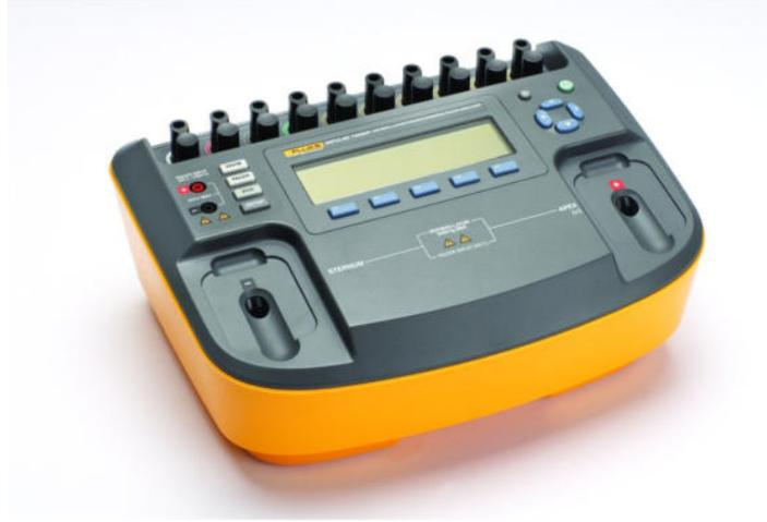
شكل رقم (12) جهاز اختبار الصدمات الكهربائية [ FLUKE ] Electrical Safety Test For Medical Equipment
