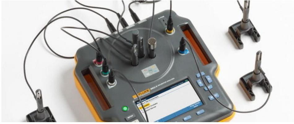
شكل رقم (14) جهاز اختبار حاضنة الأطفال [ FLUKE ] Incubator and Radiant warmer Analyzer
