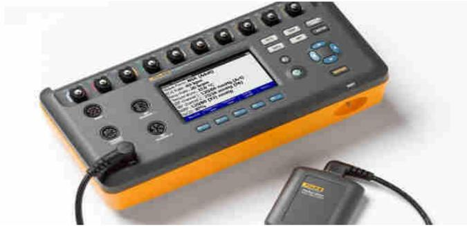
شكل رقم (7) جهاز اختبار لمحاكاة تخطيط القلب [FLUKE] Multipara Patient Simulator
